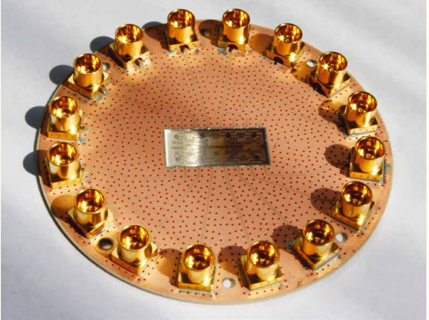
8-Qubit-Quantenprozessor basierend auf supraleitenden Materialien
