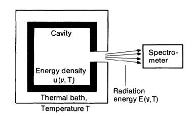
Messgrösse: Strahlungsflussdichte P(v)
