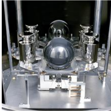
Abbildung 1: Silizium Kugel zum Messen der Avogadro Konstante
