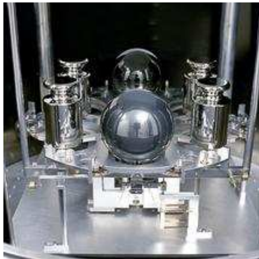
Abbildung 2: Silizium Kugel zum Messen der Avogadro Konstante
