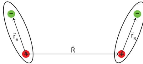
Aufgrund der grossen Bahnradien der Elektronen um den Kern eines Rydberg-Atoms erwarten wir grosse Dipolmomente für hochangeregte Zustände. Dies führt zu einer starken Kopplung zweier Rydberg-Atome, die eventuell zur Quanteninformationsverarbeitung verwendet werden kann.
