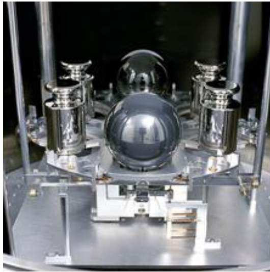
Abbildung 1: Silizium Kugel zum Messen der Avogadro Konstante
