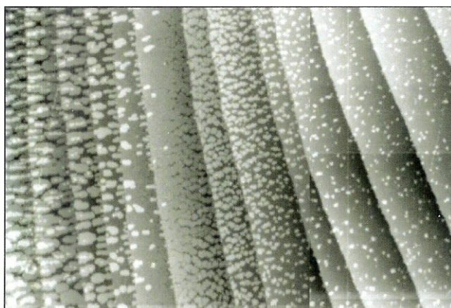
Abb. 18.7: Fe-Keil auf W(110) von 0 Atomlagen (links) bis 2.5 Atomlagen (rechts).
